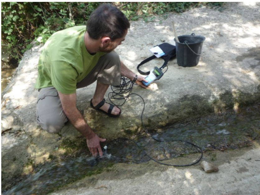
FIGURE 3.1 – Jaugeage conductimétrique d'un cours d'eau dans le département de la Drôme - Août 2009
